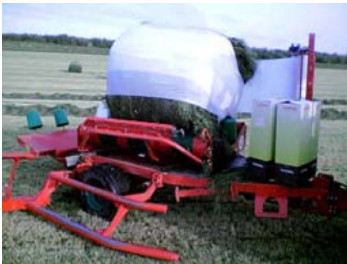
Bild 1: Bei der Ballensilierung muss eine beste Folienqualität mit 6-8 Lagen eingesetzt werden, damit ein möglichst guter Luftabschluss gewährleistet ist.
